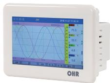
OHR-T530系列触摸彩色调节无纸记录仪采用真正的人工智能算法，仪表启动自整定功能，可以根据被控对象的特性，自动寻找最优参数以达到很好的控制效果，无需人工整定参数。控温精度基本达 $\pm 0.1^{\circ}\text{C}$ ，无超调、欠调，达国际先进水平。2路万能信号输入（可组态选择输入：标准电压、标准电流、热电偶、热电阻、频率、毫伏等）。可带1路PID控制，带1路报警输出，1个模拟量或开关量控制输出，1路DI电平输入，RS485通讯接口，以太网接口，微型打印机接口和USB接口，SD卡插座；可提供传感器配电；具有强大的显示功能，实时曲线显示，历史曲线追忆，棒图显示，报警状态显示。
