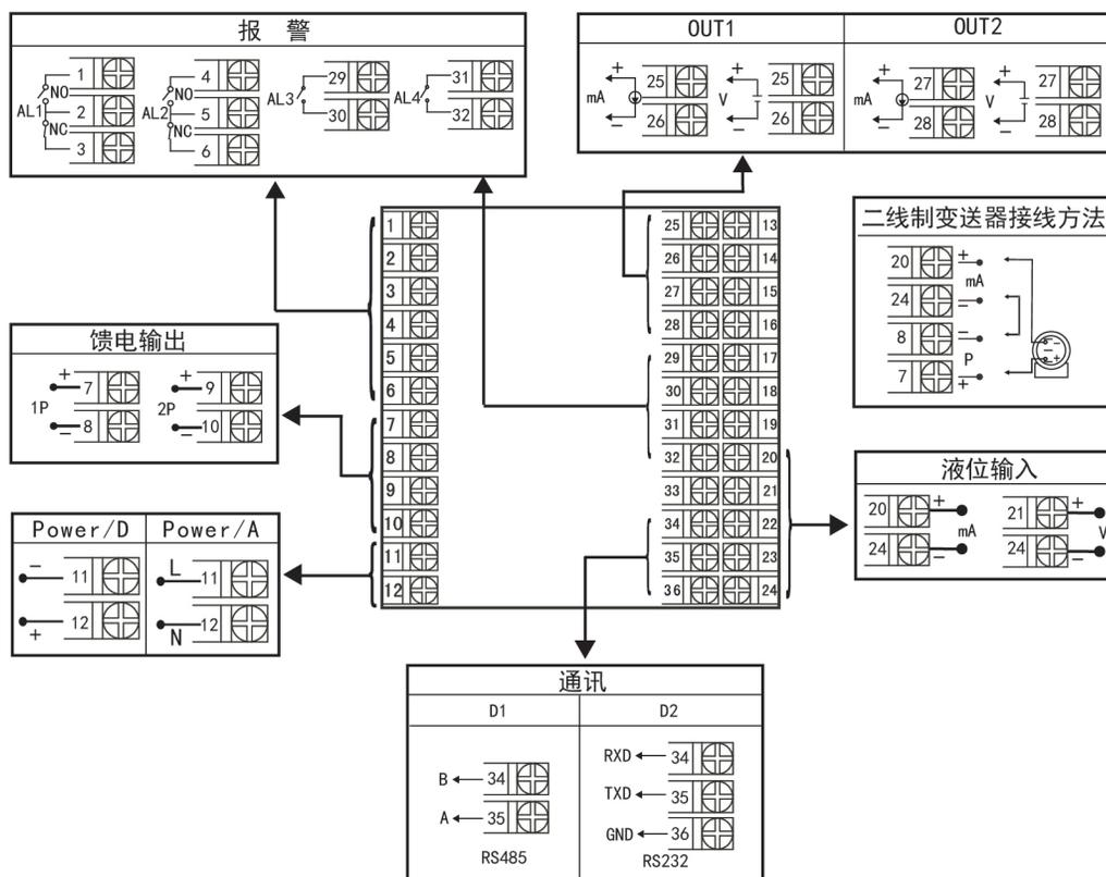
规格尺寸为A、B、C型接线图
